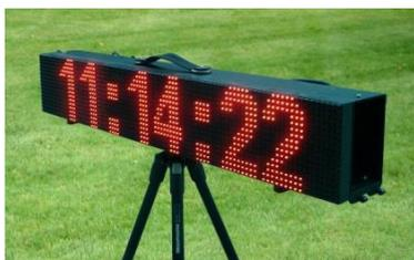
**9-значное мобильное табло** подключается к вашей системе FinishLynx и может отображать время забега и результаты, которые хорошо видны с расстояния более 60 метров. Дисплей также интегрируется с плагином ACM, для возможности автоматического отображения результатов.
